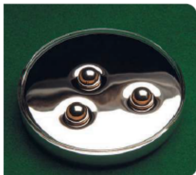
Esferas de metal flutuando sobre o mercúrio.
