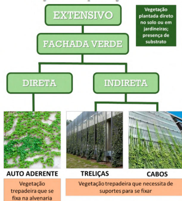
Figura 2 - Esquema geral de classificação e execução dos jardins verticais extensivos. Fonte: Scherer, Alves e Redin (2018).
