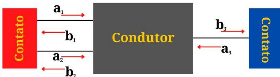
Figura 2.4: Modos nas derivações (contatos = fonte e dreno) de um condutor coerente e suas amplitudes de transmissões, representadas por  $a_{1,2,3}$  e  $b_{1,2,3}$ , aproximando-se e se afastando do condutor, respectivamente.
