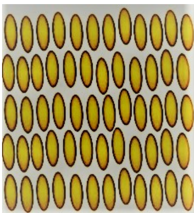
Figura 2.5: Organização ilustrativa das moléculas de um cristal líquido esmétrico-A com constituintes elipsoidais [3]. (Carvalho, 2010)
