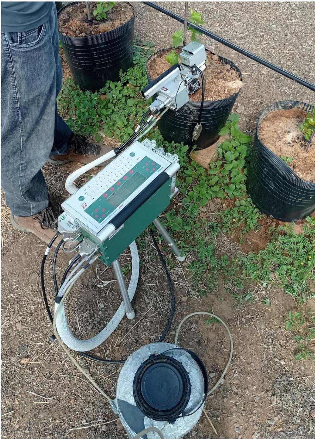
Figura 1: Analisador de gases a infravermelho portátil (IRGA) utilizado para mensurar as trocas gasosas, 14-09-2021. Fonte: Alessandro Silva, 2021.
