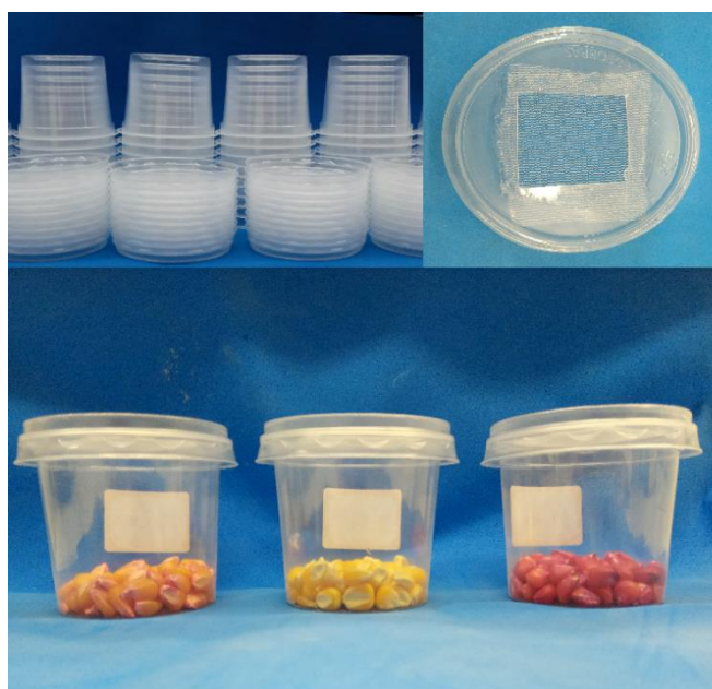
Figura 2: Arenas utilizadas no teste sem chance de escolha, para a avaliação da emergência de S. zeamais em cultivares de milho.
