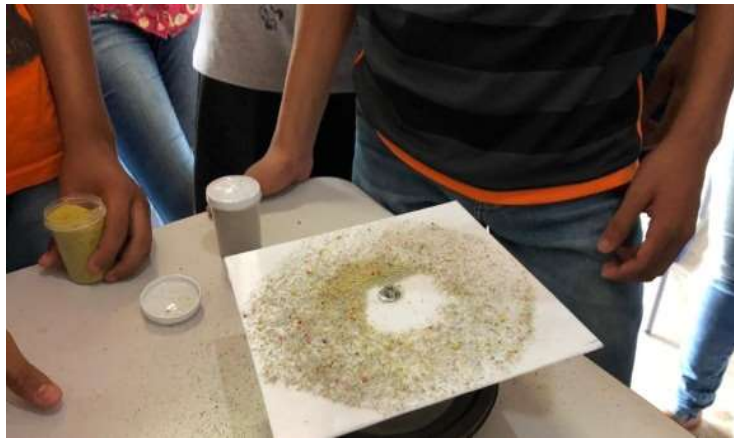
Foto 15 - Polvilhando areia colorida numa placa triangular e observando uma Figura de Chladni.
