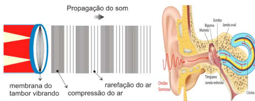
Figura 7 – Vibração longitudinal do som através da membrana de um tambor.
