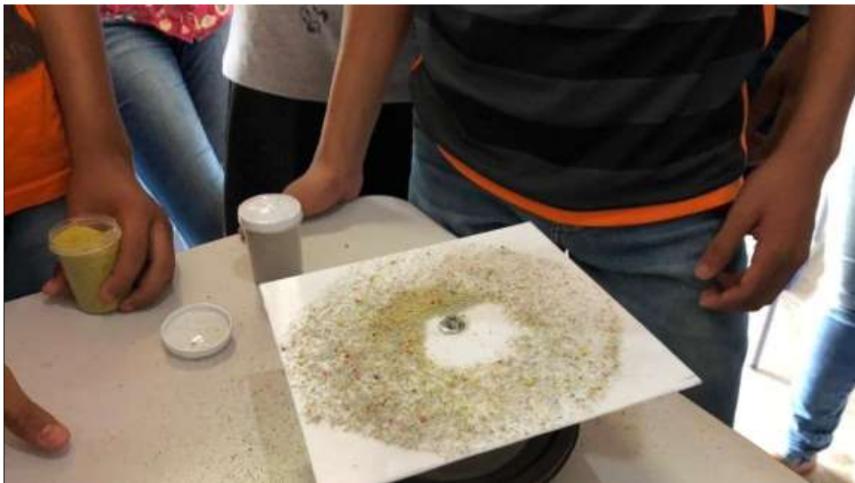
Foto 16 - Polvilhando a placa quadrada com areia e observando a formação das Figuras de Chladni.
