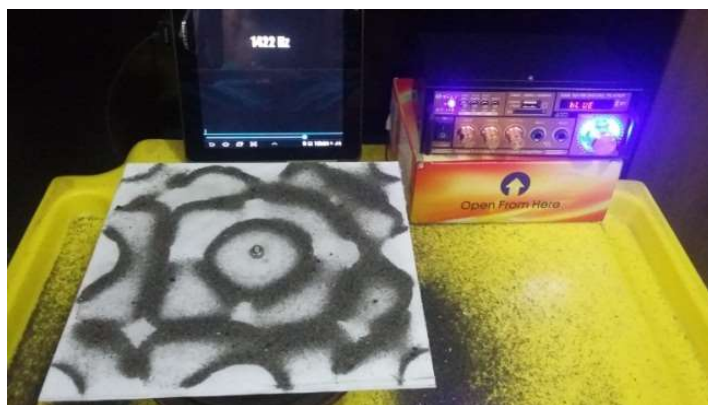
Figura 02 – Experimento das Figuras de Chladni realizado numa placa quadrada.
