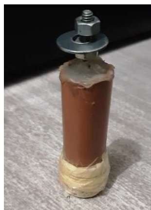
Figura 34 - Cano de PVC com parafuso centrado para acoplamento das placas ao alto-falante.
