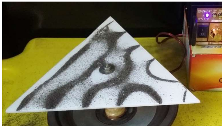
Figura 04 – Experimento realizado numa placa triangular de acrílico.
