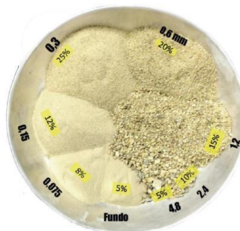
Figura 17 - Separação granulométrica de amostra de areia
