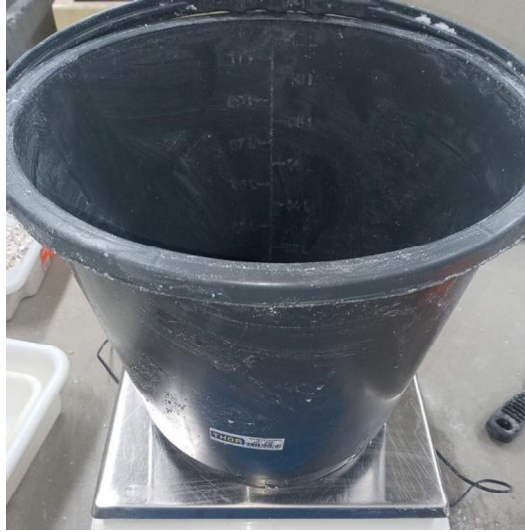
Figura 38 - Recipiente para aferição da massa unitária dos resíduos
