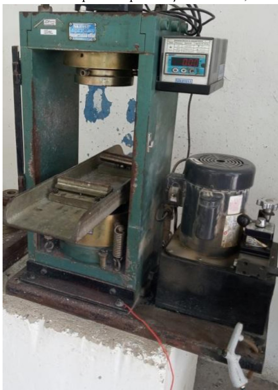
Figura 45 - Prensa com dispositivo para tração na flexão, usada nos ensaios.
