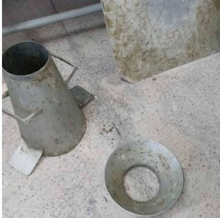
Figura 43 - Molde usado para o ensaio de abatimento
