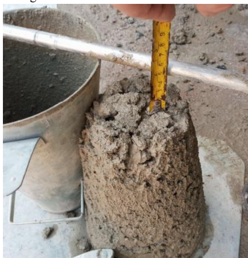
Figura 58 - Abatimento de tronco de cone
