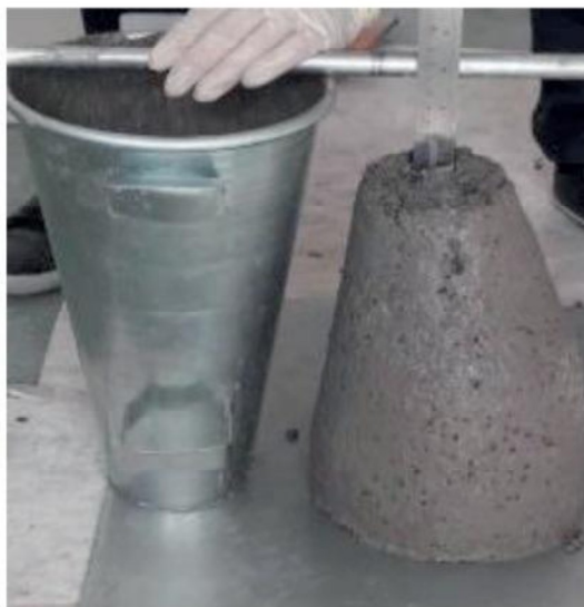
Figura 27 - Exemplo real de medição do abatimento
