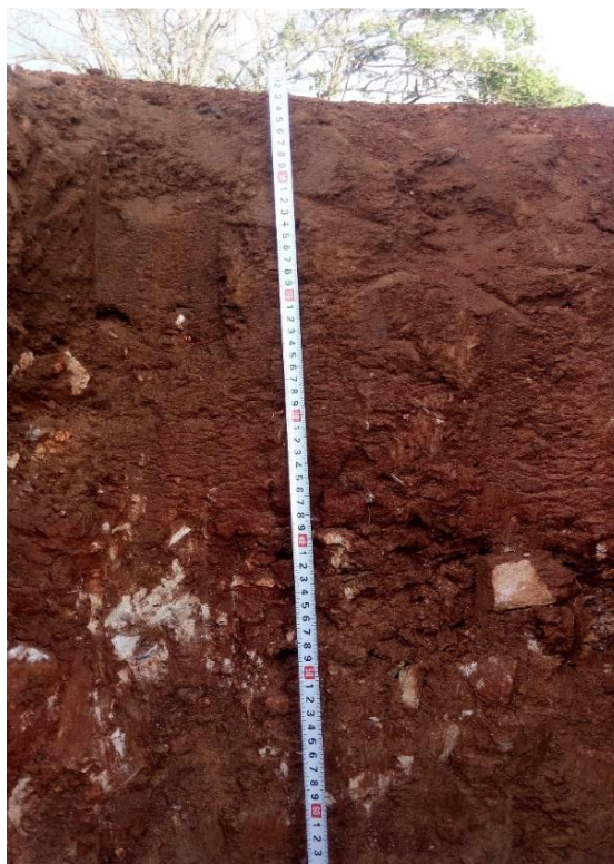
Figura 5. Representação do perfil de um Cambissolo Háplico Tb Eutrófico típico da área de estudo.
