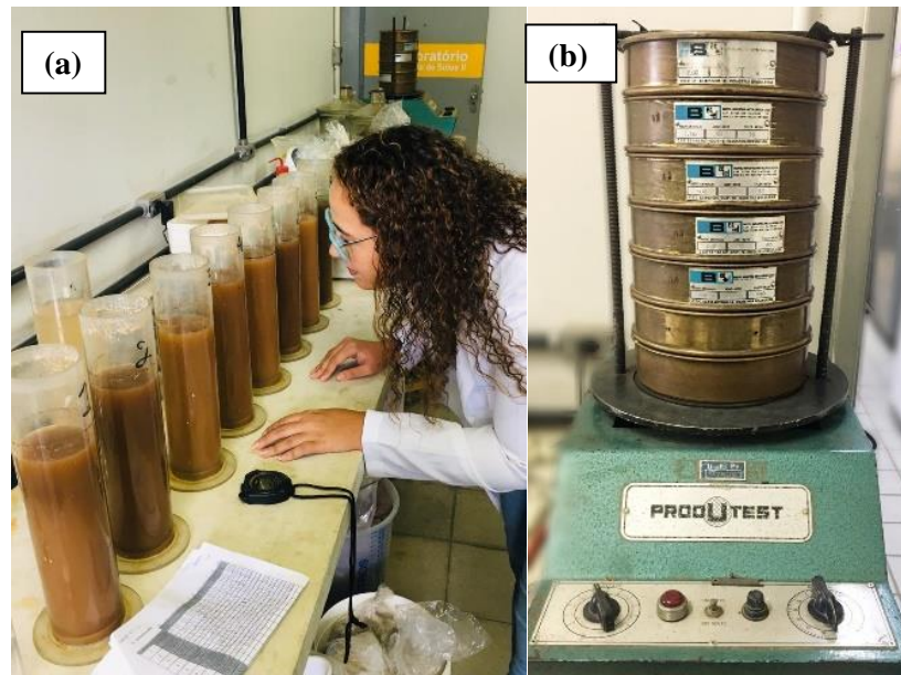
Figura 10. Determinação da distribuição granulométrica do solo por sedimentação (a) e por peneiramento (b).
