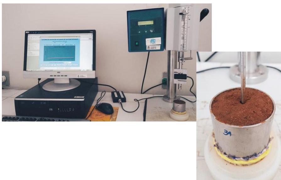
Figura 8 – Penetrômetro eletrônico de bancada utilizado nos ensaios para a determinação da resistência do solo a penetração de raízes
