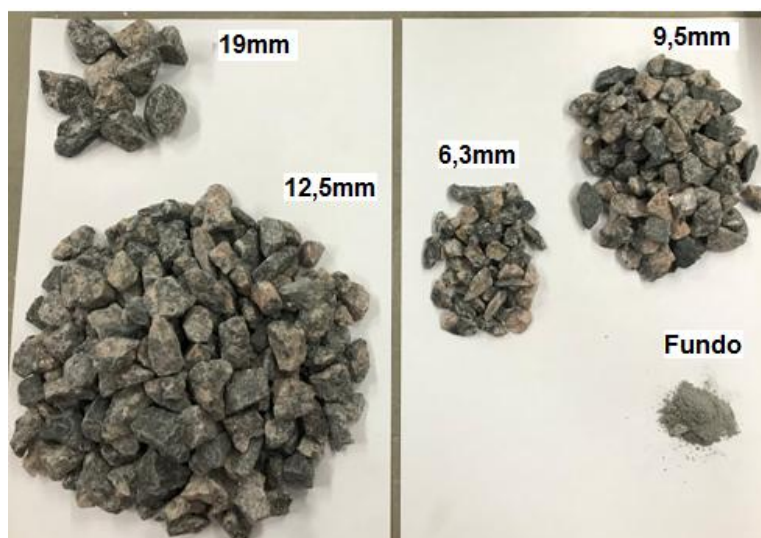
Figura 29 - Agregado graúdo retido em cada peneira, apenas na primeira etapa do peneiramento.
