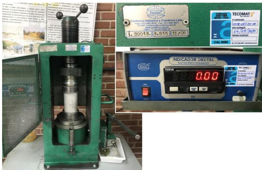
Figura 6 - Prensa manual com realização do ensaio de compressão no CP's.
