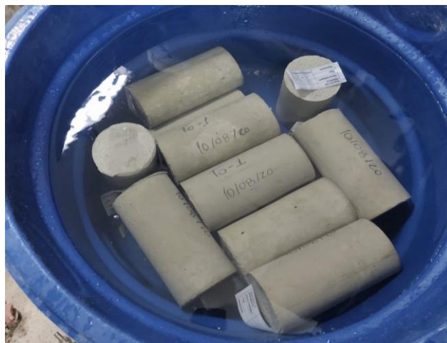
Figura 36 - CP's identificados e reservados em caixa d'água.
