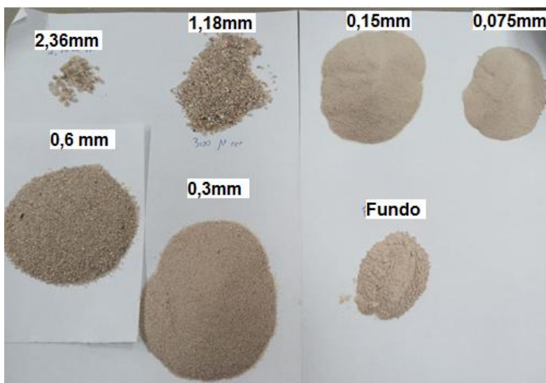
Figura 26 - Agregado miúdo retido em cada peneira.
