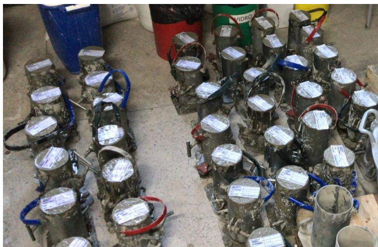
Figura 35 - CP's moldados e organizados no Laboratório de Materiais.
