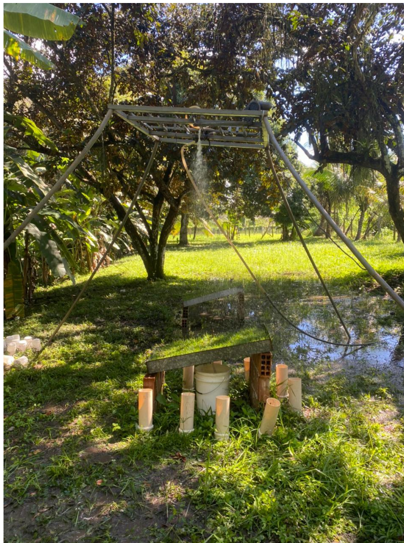
Figura 9 – Ensaio experimental do telhado verde sob a chuva simulada na área do Departamento de Agronomia, UFRPE.
