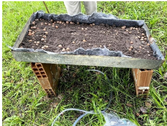
Figura 14: Passos 3 e 4 – Sob a manta, as camadas de substrato e argila expandida. Fonte: Autora.
