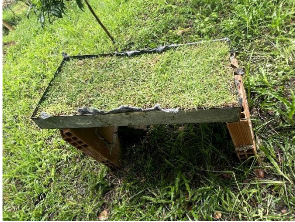
Figura 15: Passo 5 – Plantio das placas de grama esmeralda. Fonte: Autora
