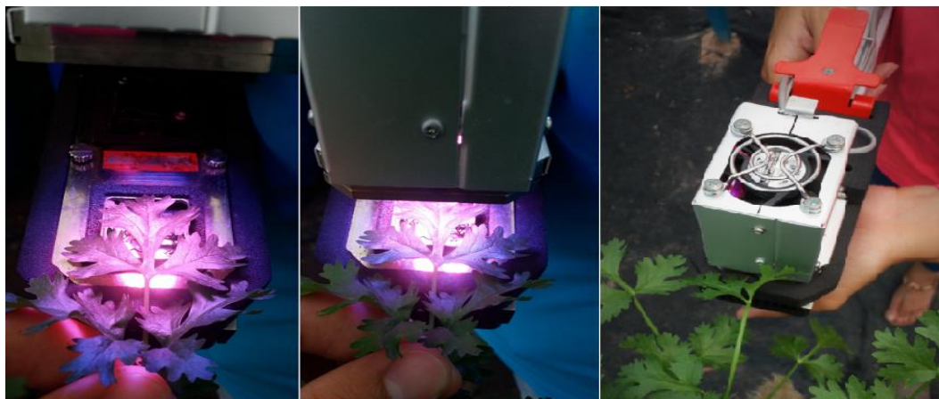
Figura 10. IRGA - Analisador de gás infravermelho portátil, com fonte luminosa externa.
