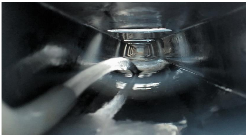
Figura 7. Vista interna do perfil hidropônico, vazão de 4 L min -1 .
