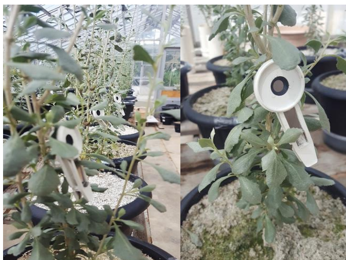
Figura 4 – Aclimação das folhas ao escuro para determinação de fluorescência da clorofila a com auxílio de fluorômetro portátil.
