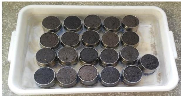
**Figura 3.** Amostras não deformadas de solo saturadas.
