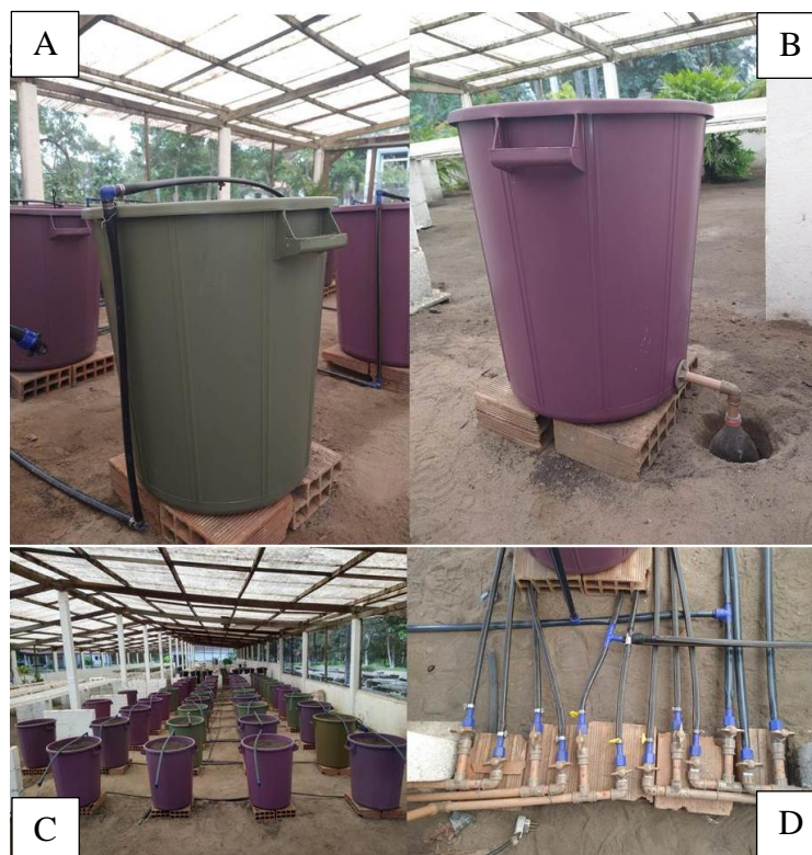
Figura 6 - (A) Estrutura do sistema de irrigação em cada parcela experimental. (B) Lisímetro de drenagem. (C) Sistema de irrigação montado em toda a área experimental. (D) 12 registros de controle do sistema de irrigação. Fonte: Autora (2022).
