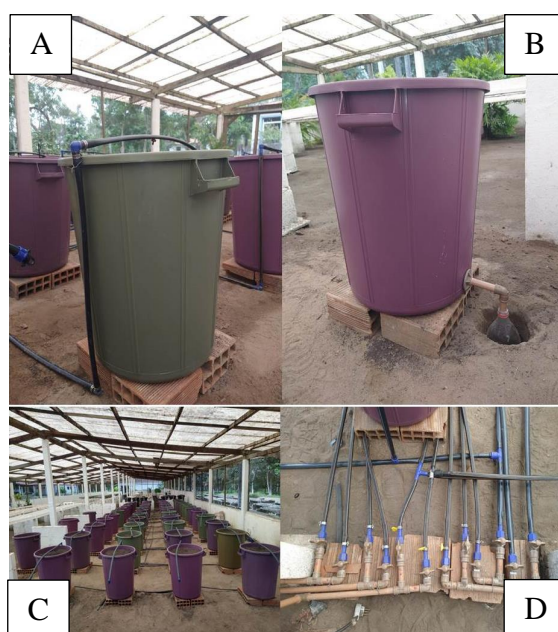
Figura 6 - (A) Estrutura do sistema de irrigação em cada parcela experimental. (B) Lisímetro de drenagem. (C) Sistema de irrigação montado em toda área experimental. (D) 12 registros de controle do sistema de irrigação. Fonte: Autora (2022).
