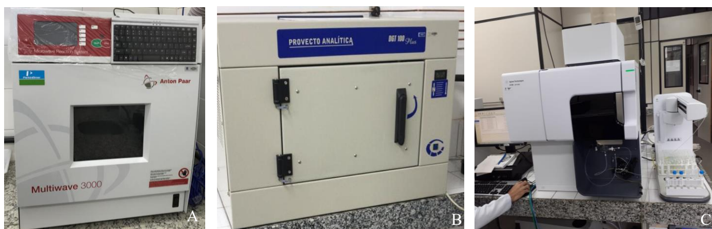
Figura 6. A. Microondas Multiwave 3000 Anton Paar®. B. Microondas Provecto Analítica DGT 100 Plus®. C. Espectrômetro ICP-OES Agilent 5100®.
