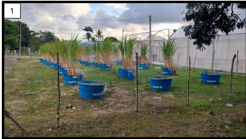
Figura 5 – Disposição dos lisímetros no local experimental. Imagem aos (1) 150 DAP; (2) 224 DAP.
