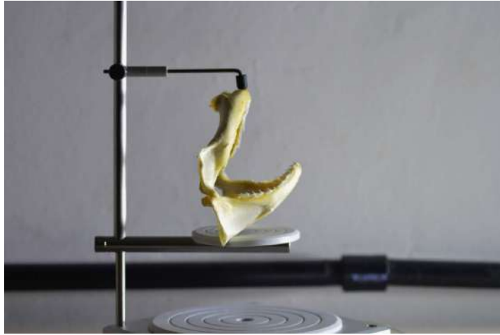
Figura 15 – Exemplo do suporte usado para fixar a arcada.
