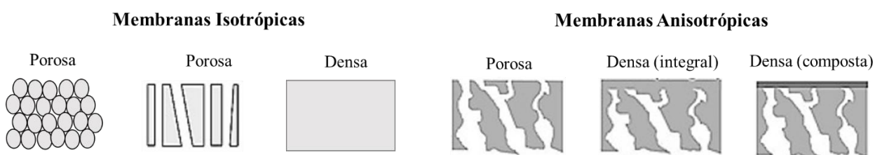
Figura 6 – Estrutura morfológica dos tipos de membranas.
