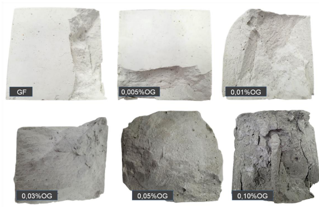
Figura 19. Corpos de prova após ensaios de resistência à compressão na relação a/g 0,50
