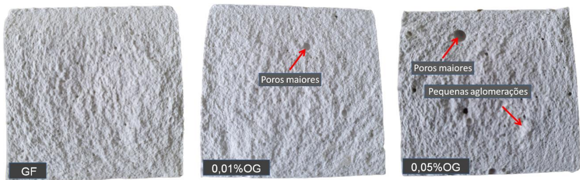
Figura 21. Corpos de prova após ensaios de resistência à flexão na relação a/g 0,50
