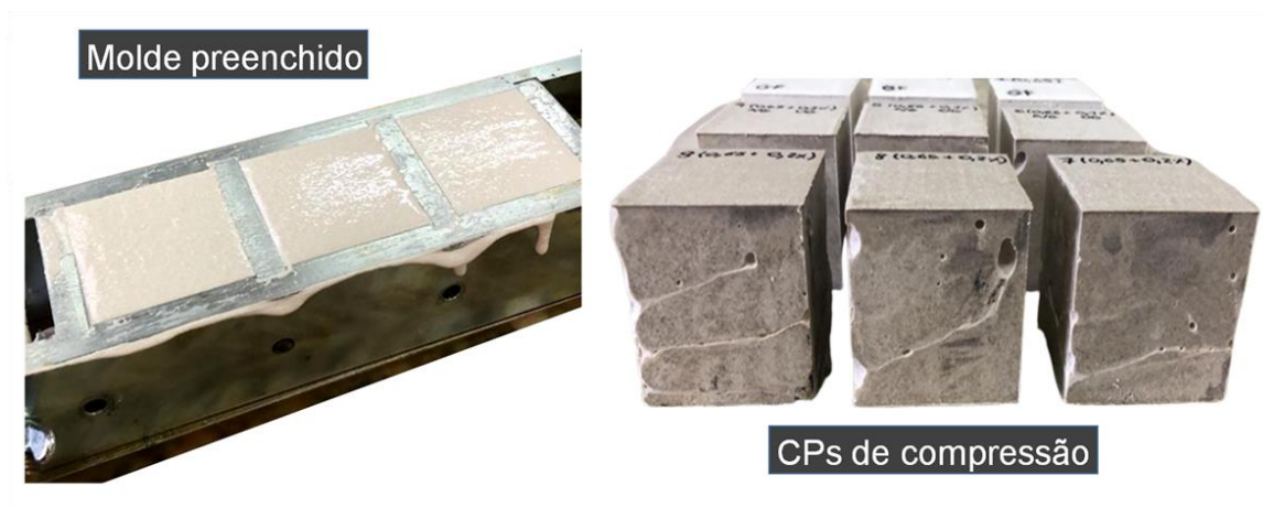
Figura 16. Molde preenchido com a pasta de gesso e CPs com defeitos estruturais
