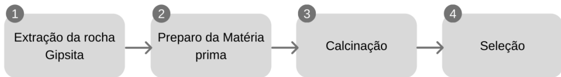
Figura 1. Esquema sequencial da fabricação do gesso
