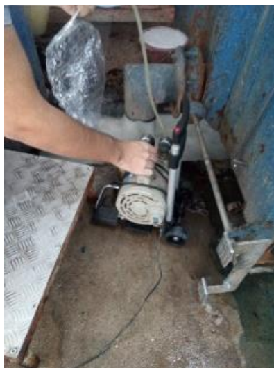
Figura 2. Sistema de coleta do ar odorante Fonte: (Autor)
