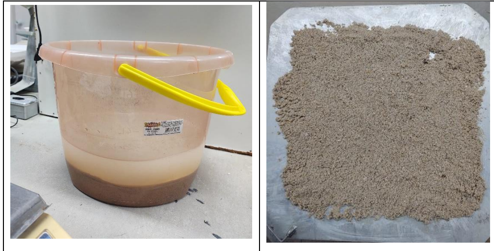
Figura 14 – Areia submersa em água (figura à esquerda) e em processo de secagem (figura à direita).
