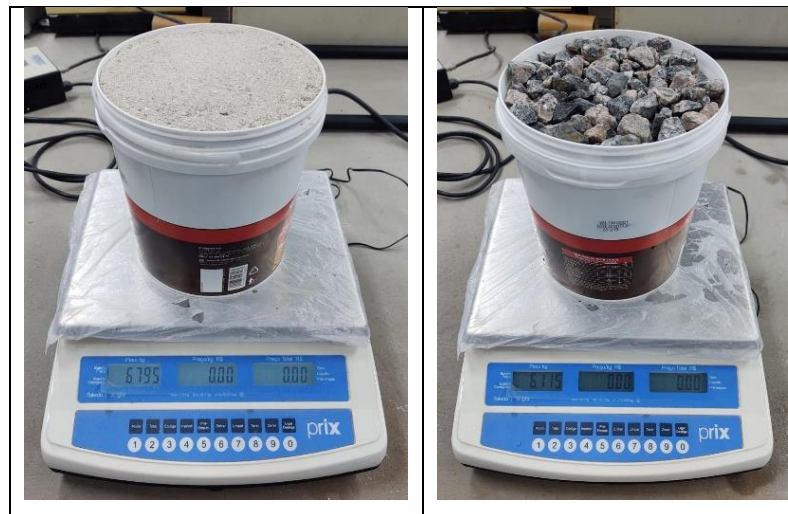
Figura 19 – Balde com os agregados miúdo (figura à esquerda) e graúdo (figura à direita).
