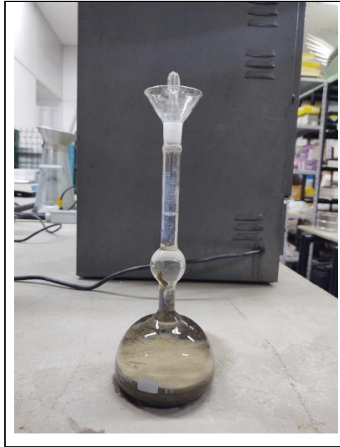
Figura 12 – Leitura do volume do frasco de Le Chatelier contendo xileno + cimento.
