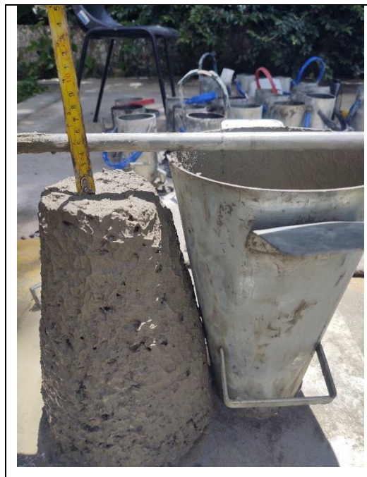
Figura 23 – Ensaio de abatimento utilizando o limite de 50 \pm 10 mm.
