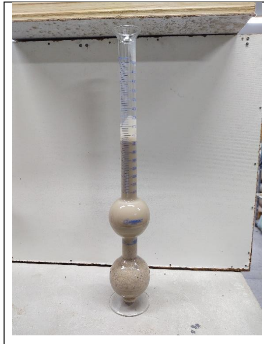
Figura 20 – Areia no frasco de Chapman para determinação do teor de umidade.
