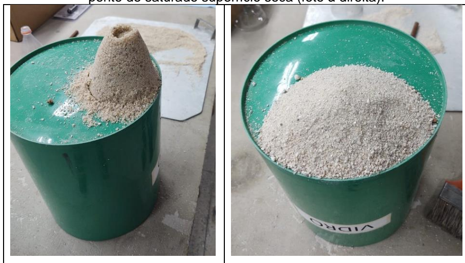
Figura 15 – Ensaio de tronco cônico: areia com umidade superficial (foto à esquerda) e areia seca no ponto de saturado superfície seca (foto à direita).
