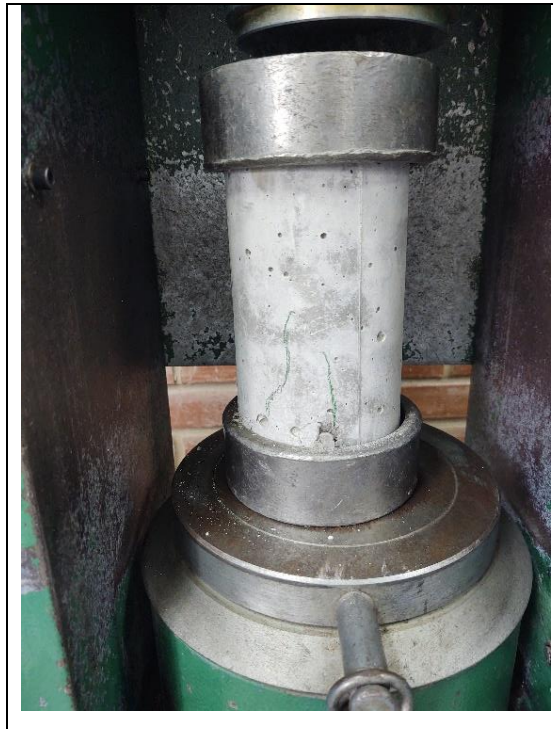
Figura 25 – Representação do ensaio de compressão.
