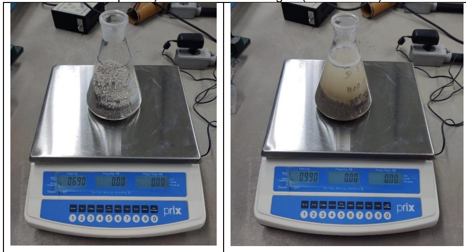
Figura 16 – Utilização do frasco aferido em ensaio de massa específica de areia: frasco + areia (foto à esquerda) e frasco + areia + água (foto à direita).
