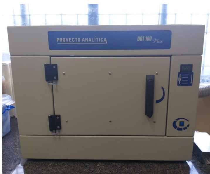
Figura 26 – Forno micro-ondas utilizado na digestão das amostras, brancos e materiais de referência.
