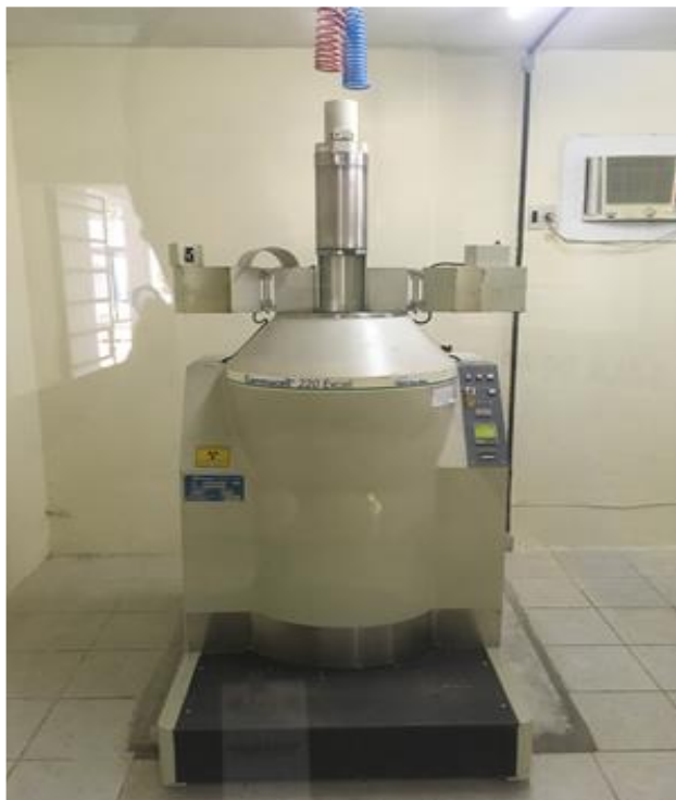
Figura 24 – Irradiador com fonte de \text{Co}^{60} Gammacell 220 Excel-MDS Nordion.
