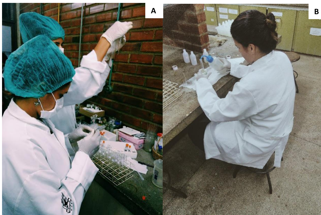
Figura 11. Preparo das amostras para digestão (A), filtração e diluição (B) no Laboratório de Química Aplicada a Fitoterápicos (LaqaF) da Universidade Federal Rural de Pernambuco.
