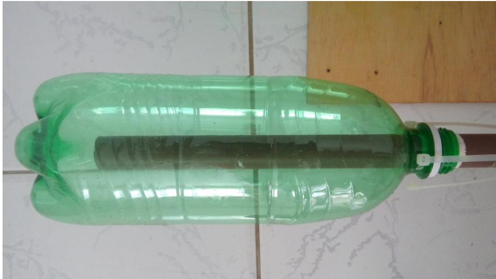
Figura C.39- Tubo do conduto a 2 cm da base da garrafa PET.
