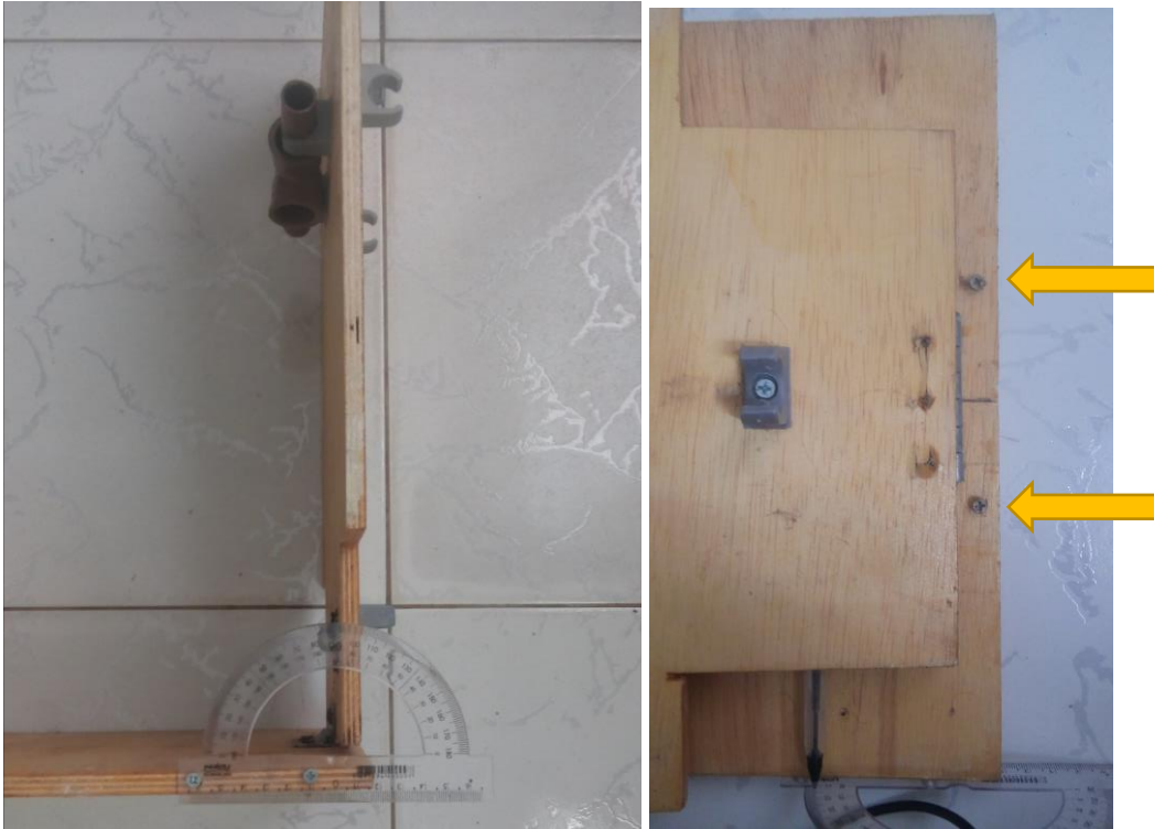
Figura C.48- (a) Montagem do transferidor escolar 180^\circ (vista lateral) e (b) parafusos apoiadores (vista superior).
