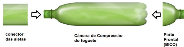
Figura C.20- Montagem das garrafas pet.
