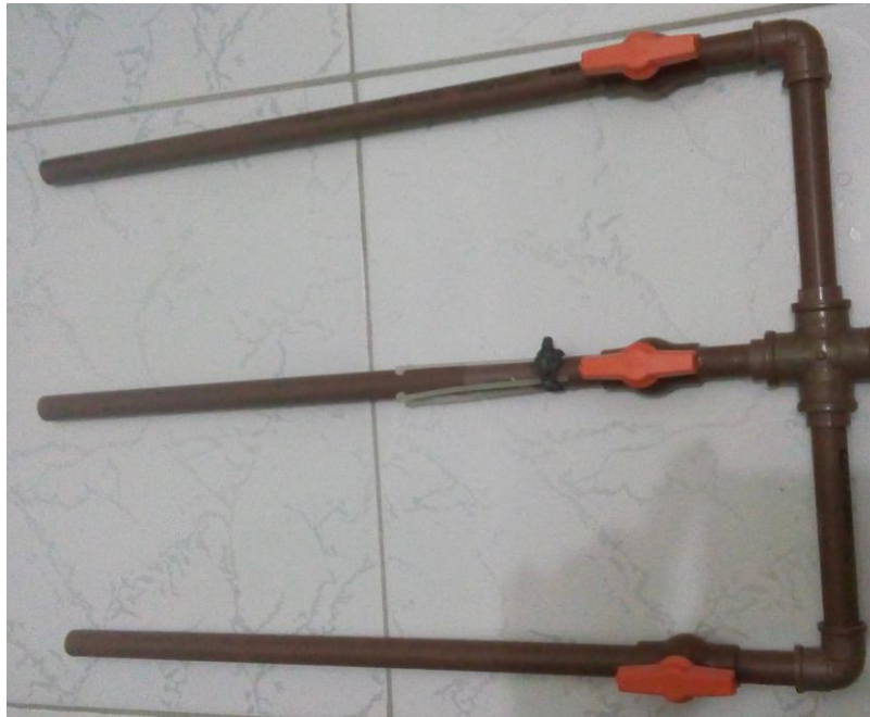
Figura C.30- Condutores dos foguetes + junção dos condutores.
