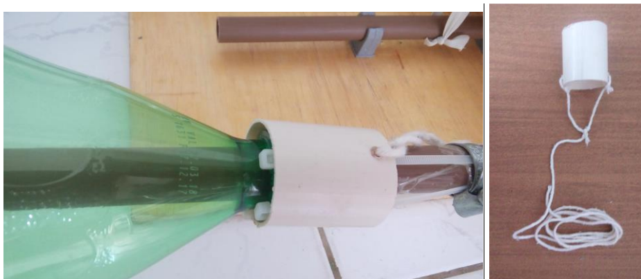
Figura C.42- Montagem do acionador do foguete e (b) Pedaço de cano de PVC para esgoto com 40 mm de diâmetro e 4 cm de comprimento (acionador).
