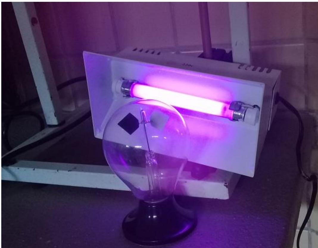
Figura 4.6 – Radiômetro de Crookes e fonte de luz negra.
