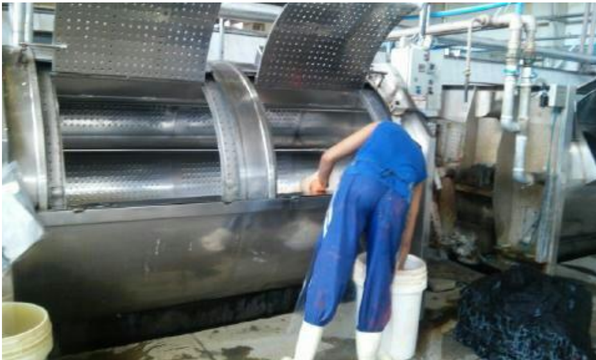
Figura 6. Máquinas de lavar de tambores rotativos de porte industrial da “Lavanderia X”.
