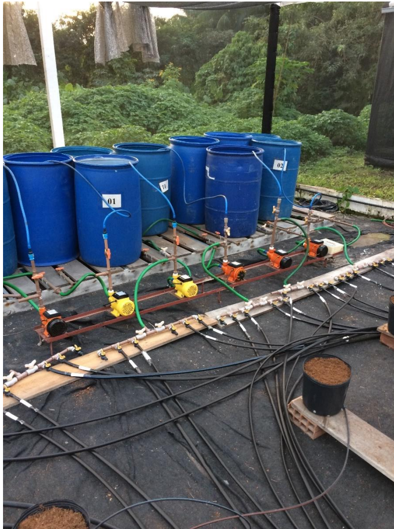
Figura 3. Sistema de armazenamento, bombeamento e distribuição das soluções nutritivas.
