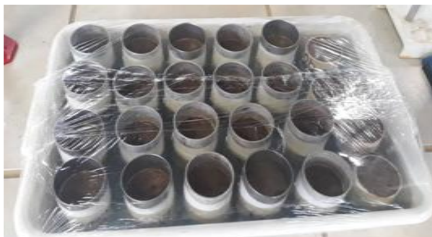
Figura 12. Amostras em saturação.
