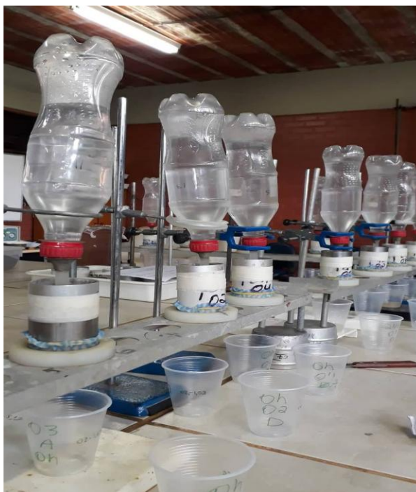
Figura 13. Amostras em teste de condutividade hidráulica.
