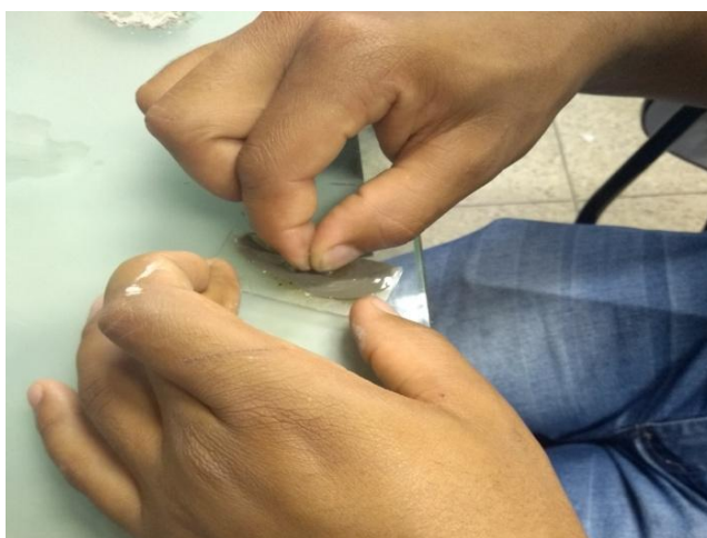
Figura 10. Polimento manual com pasta diamantada (6 a 12 \mu\text{m} ).
