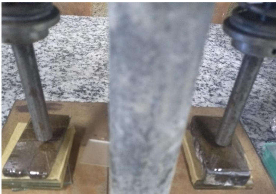
Figura 9. Colagem das peças nas lâminas de vidro.
