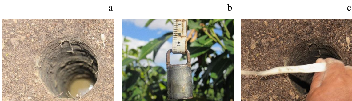
Figura 9. Medição da profundidade do lençol freático. a) poço aberto para instalação do PO com presença de lençol freático; b) ploper; c) uso do ploper no poço.
