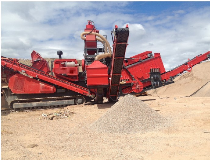
Foto 5 – Correia transportadora e resíduo após peneiramento Fonte: Plano de Gestão Integrada de Resíduos Sólidos da empresa Ciclo Ambiental
