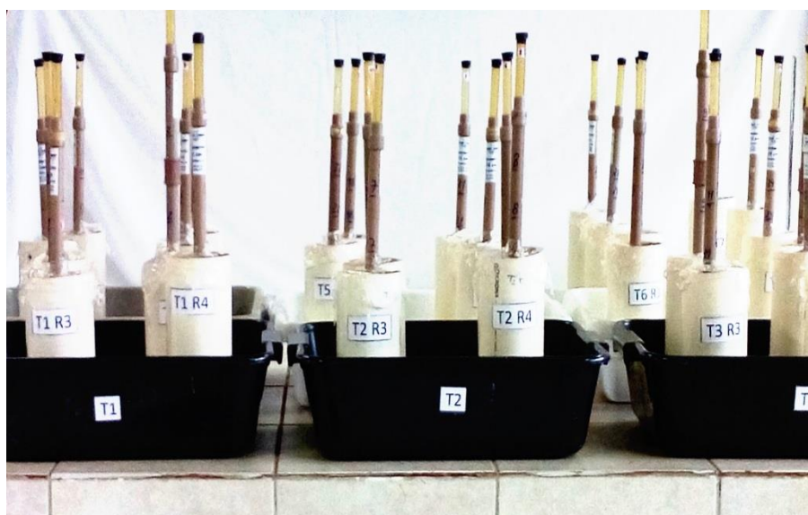
Figura 4. Colunas de PVC preenchidas com solo durante o período de 24 horas esperando que o excesso de água tenha drenado por ação gravitacional
