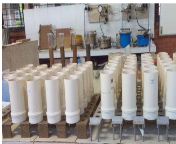
Figura 3. A) Colunas confeccionadas com tubo de PVC com diâmetro interno 100 mm e altura 200 mm; B) Colunas de PVC dispostas uma ao lado da outra, para posterior preenchimento com as amostras de solo com densidade próxima à encontrada em campo
