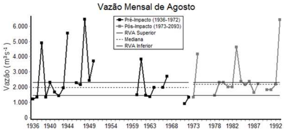
Figura 87. Série temporal da vazão mensal de agosto do Rio São Francisco no município de Pão de Açúcar antes e depois da construção do reservatório de Sobradinho.
