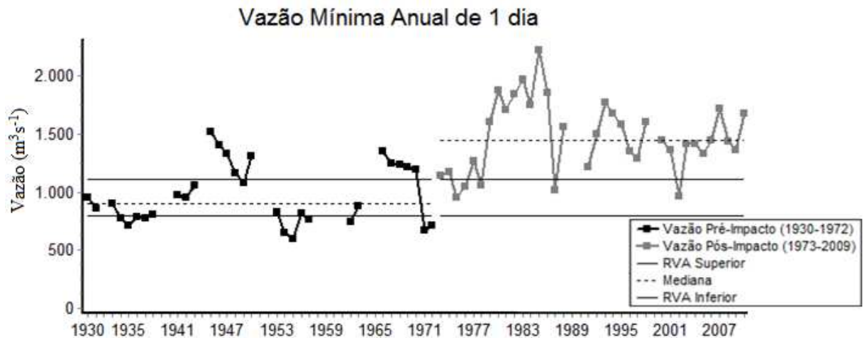
Figura 61. Série temporal da vazão mínima anual diária, a cada ano, do Rio São Francisco a jusante da barragem de Sobradinho antes e depois da construção do reservatório.
