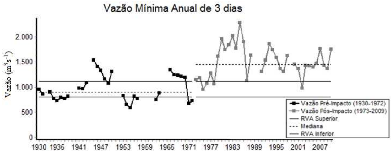
Figura 62. Série temporal da vazão mínima anual de 3 dias, a cada ano, do Rio São Francisco a jusante da barragem de Sobradinho antes e depois da construção do reservatório.
