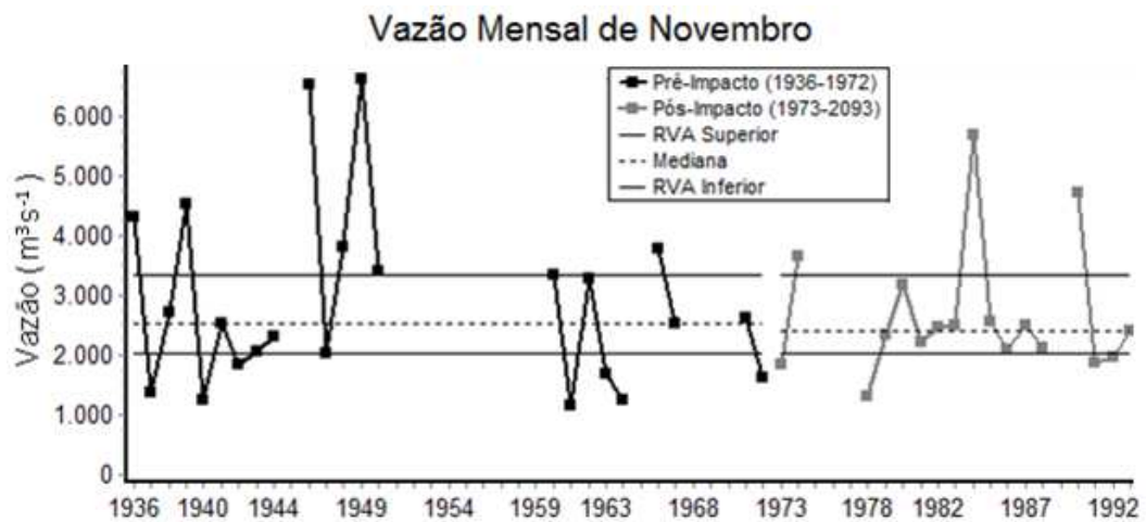
Figura 78. Série temporal da vazão mensal de novembro do Rio São Francisco no município de Pão de Açúcar antes e depois da construção do reservatório de Sobradinho.
