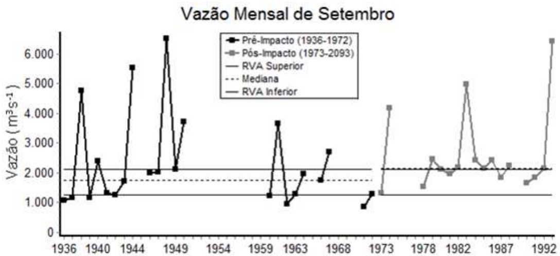
Figura 88. Série temporal da vazão mensal de setembro do Rio São Francisco no município de Pão de Açúcar antes e depois da construção do reservatório de Sobradinho.
