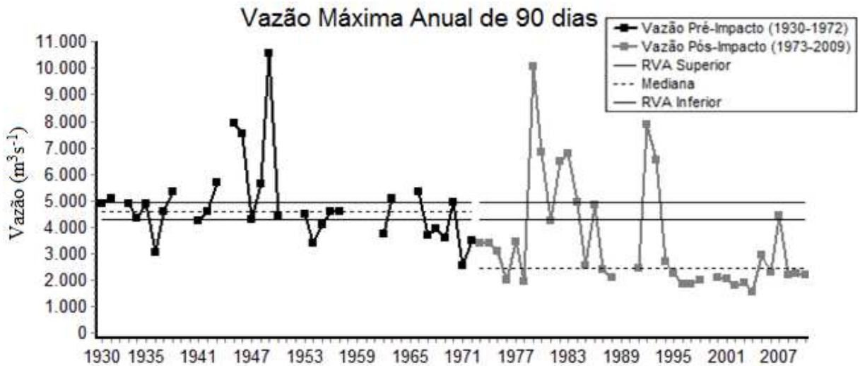
Figura 70. Série temporal da vazão máxima anual de 90 dias, a cada ano, do Rio São Francisco a jusante da barragem de Sobradinho antes e depois da construção do reservatório.
