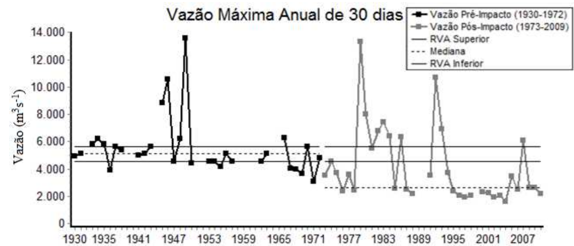
Figura 69. Série temporal da vazão máxima anual de 30 dias, a cada ano, do Rio São Francisco a jusante da barragem de Sobradinho antes e depois da construção do reservatório.
