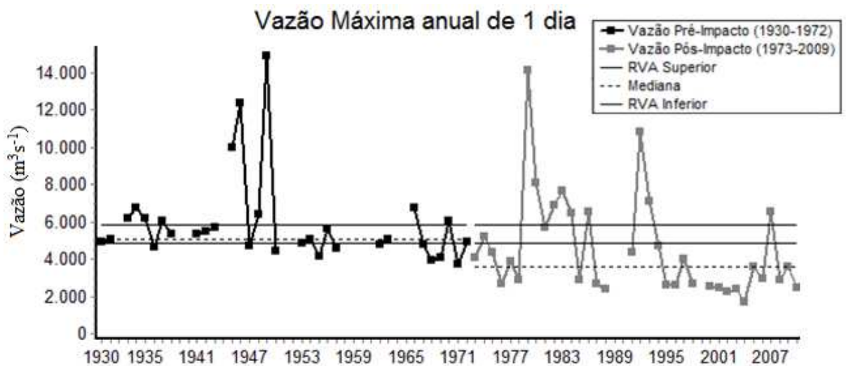
Figura 66. Série temporal da vazão máxima anual diária, a cada ano, do Rio São Francisco a jusante da barragem de Sobradinho antes e depois da construção do reservatório.
