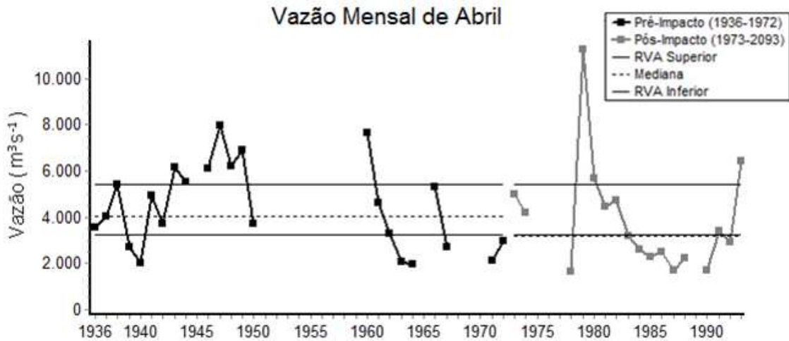
Figura 83. Série temporal da vazão mensal de abril do Rio São Francisco no município de Pão de Açúcar antes e depois da construção do reservatório de Sobradinho.
