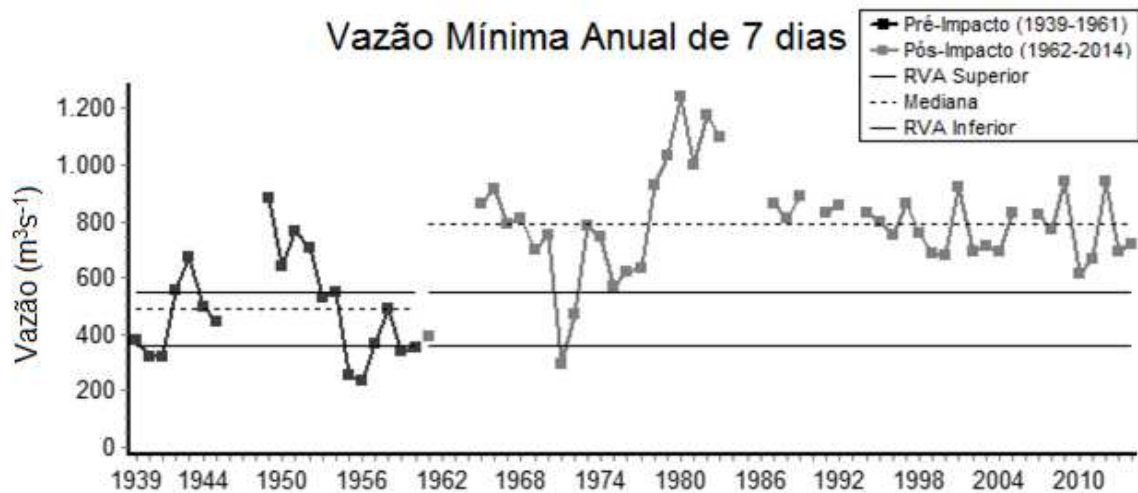
Figura 34. Série temporal da vazão mínima de 7 dias, a cada ano, do Rio São Francisco a jusante da barragem de Três Marias antes e depois da construção do reservatório.
