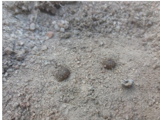
Figura 6: Teste do tempo de penetração da gota de água realizado na área de Caatinga. São João-Pe.
