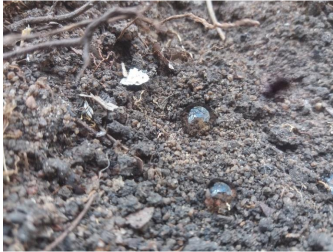
Figura 5: Teste do tempo de penetração da gota de água realizado na área de mata. Brejão-Pe.
