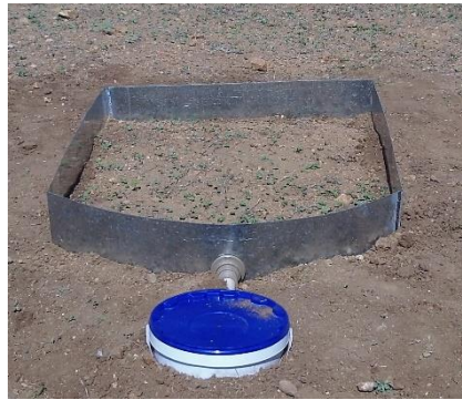
Figura 7. Calha coletora para medição do escoamento superficial.
