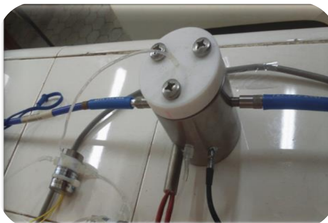
Figura 5: Cella em fluxo-batelada desenvolvida por Brasil e Reis (2016) e empregada no sistema proposto.
