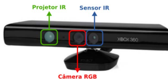
Figura 2.7 – Dispositivo Microsoft Kinect usado para captura de imagens RGB-D. Em destaque o projetor IR, o sensor IR e a câmera RGB.
