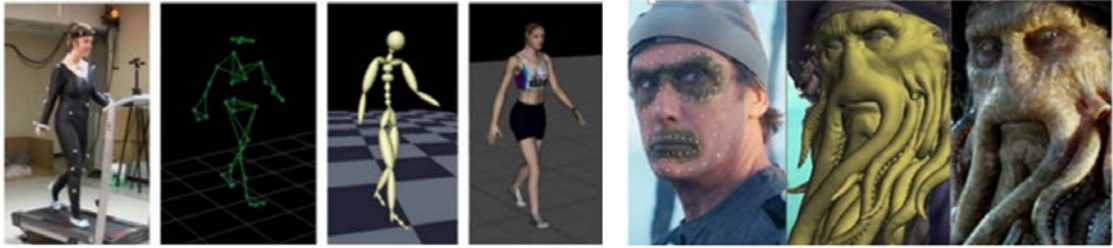
Figura 3.1 – Utilização de marcadores pontuais para o rastreamento de corpos e expressões faciais humanas. Imagens retiradas respectivamente de [28] e [29].
