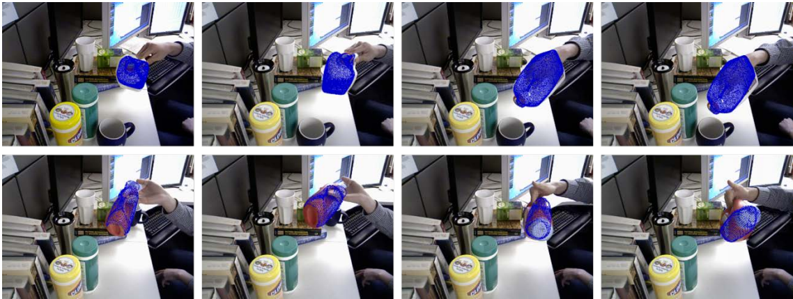
Figura 5.11 – Poses visualmente imprecisas obtidas durante o rastreamento baseado em PSO. Acima os quadros q_{384} , q_{524} , q_{618} e q_{661} da sequência real “Milk” e abaixo os quadros q_{421} , q_{465} , q_{619} e q_{675} da sequência real “Tide”.
