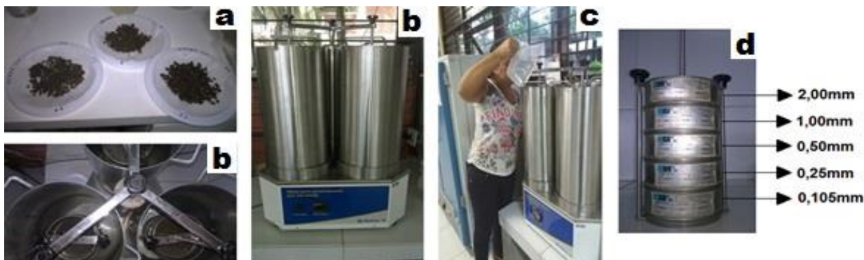
Figura 9 - Detalhe do equipamento usado no ensaio de estabilidade via úmida: a) umedecimento das amostras; b) aparatos do equipamento; c) equipamento; d) peneiras
