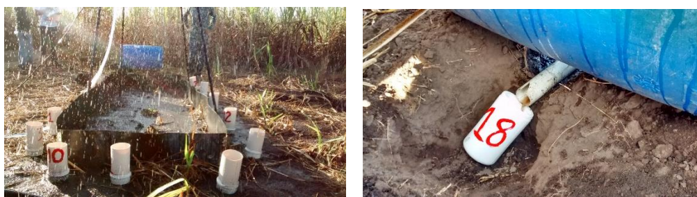
Figura 5 - Coleta de sedimentos de solo erodido, durante uma simulação de chuva, de um sistema produtivo de cana-de-açúcar.
