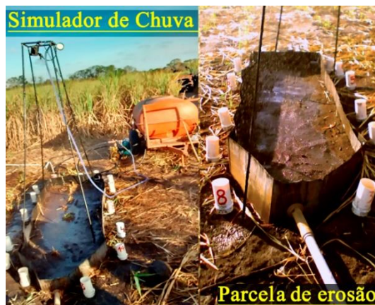
Figura 4 - Avaliação do comportamento das chuvas simuladas na parcela de erosão, em um sistema produtivo de cana-de-açúcar.
