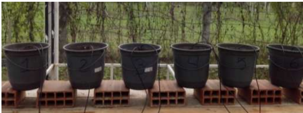
FIGURA 5 - Conjunto solo, vaso e sensores na bancada na casa de vegetação.
