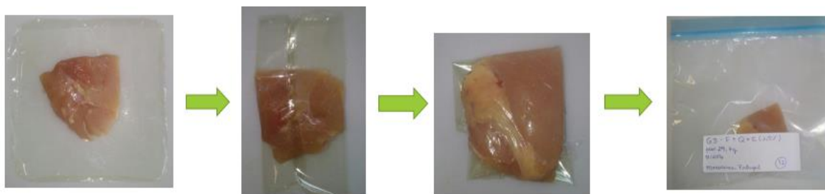
FIGURA 6: Amostra de sobrecoxa de frango sendo embalada em filme de quitosana, seguido da embalagem em sacolas de polipropileno
