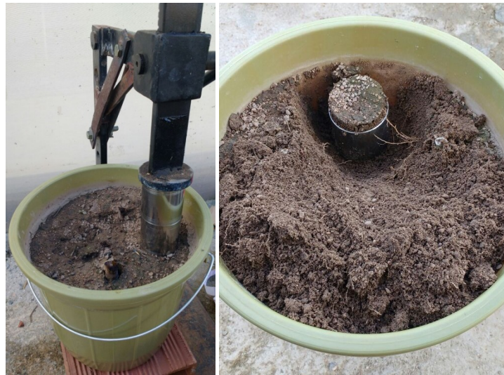
Figura 8 – Coleta dos solos nos vasos em anéis volumétricos
