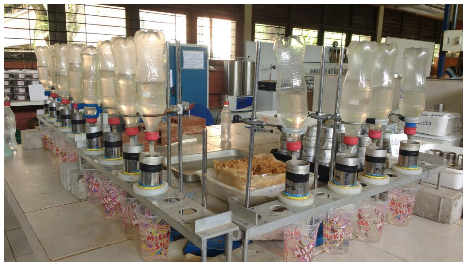
Figura 11- Permeâmetros de carga constante usados nos ensaio de Ksat
