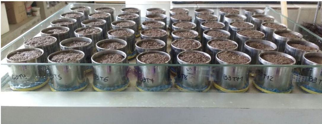
Figura 12 – Amostras dos solos na mesa de tensão, usada para equilíbrio à 1,6 e 10 kPa
