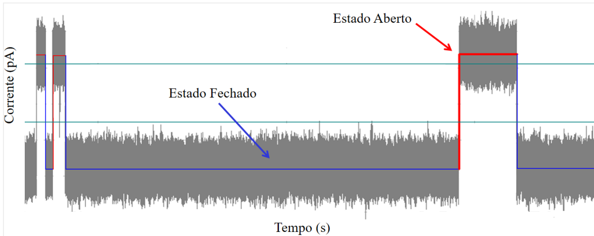
Figura 13: Idealização dos dados realizadas no Software pClamp . O programa identifica os estados de condutâncias (abertos e fechados) do registro da corrente iônica através dos níveis de condutância de cada estado.
