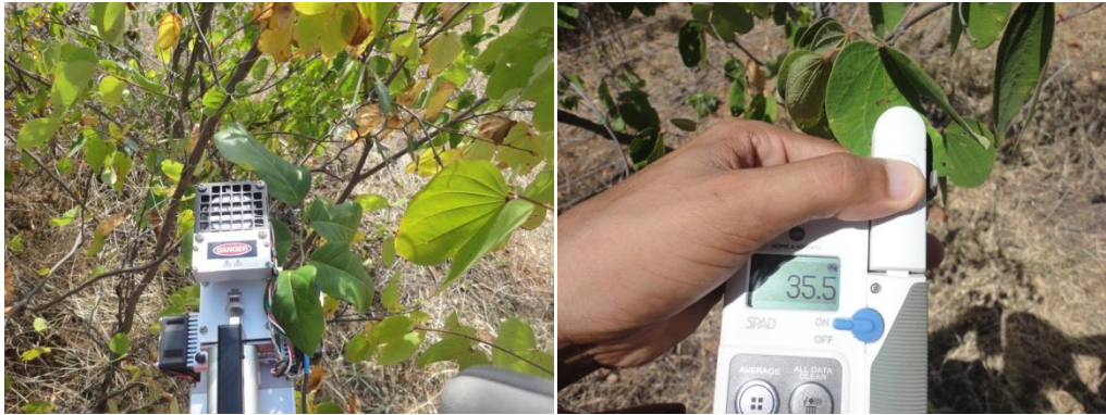
Analisador de gás por infravermelho (IRGA) (esquerda) e medidor de índice SPAD (direita)
