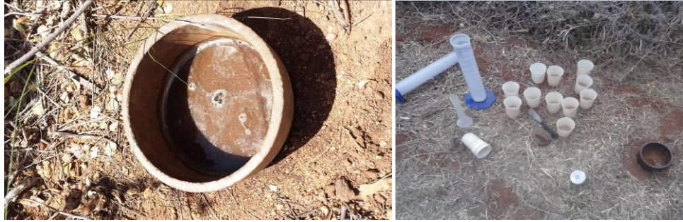
Figura 6. Ensaios de infiltração com infiltrômetro de anel simples com (D =150 mm)
