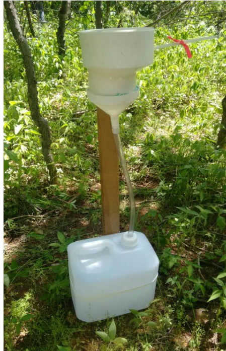
Figura 3. Pluviômetro manual para monitoramento da precipitação interna em área de Caatinga
