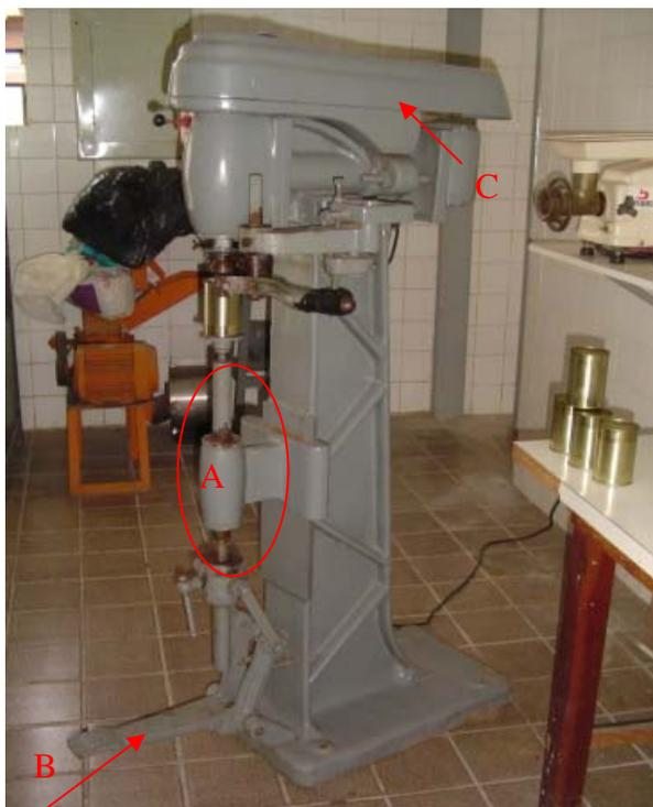
Figura 5 – Detalhe do mecanismo para a recravação: A – êmbulo; B – pedal;
