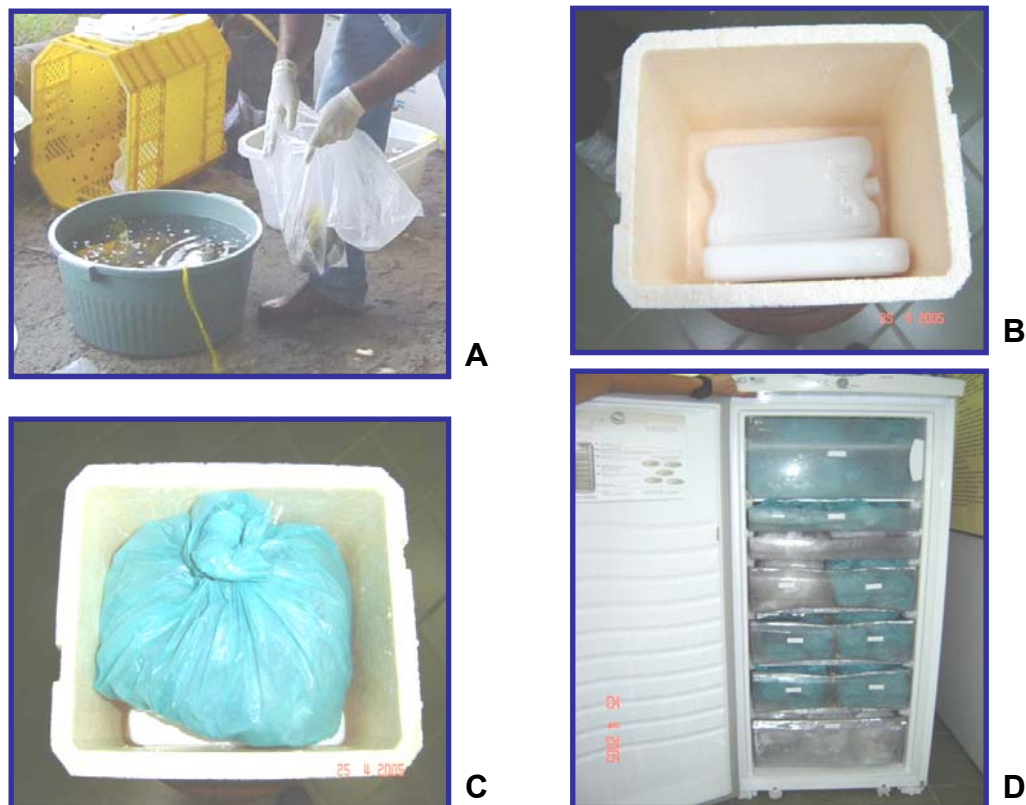
Figura 3: Acondicionamento das amostras: A - Armazenamento da amostra em sacos plásticos íntegros; B - Caixa térmica individual com gelo reciclável; C - Amostra acondicionada em caixa térmica; D - Armazenamento das amostras em congelador doméstico.
