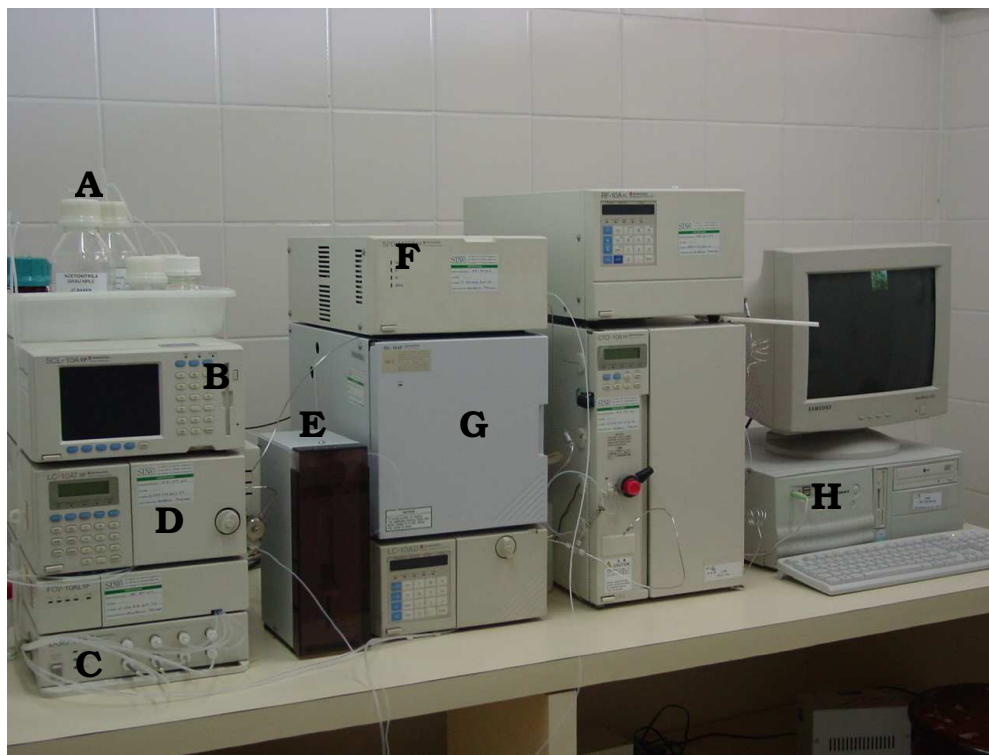
Figura 5. Componentes de um sistema cromatográfico: (A) Fase móvel; (B) Sistema Controlador; (C) Desgaseificador; (D) Bomba; (E) Injetor automático; (F) detector; (G) Forno contendo coluna cromatográfica; (H) Computador para aquisição e processamento de dados. Fonte: Instituto de tecnologia de Pernambuco.
